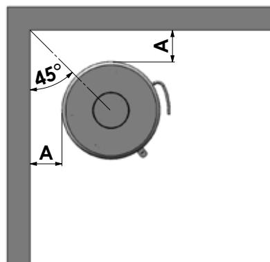
Af hensyn til varmecirkulation, rengøring og evt. indvendig rensning af ovn, anbefales afstand til murværk at være 10-15 cm. Et lag tapet bliver normalt, når det er påsat murværk, betragtet som ikke-brændbart materiale.
